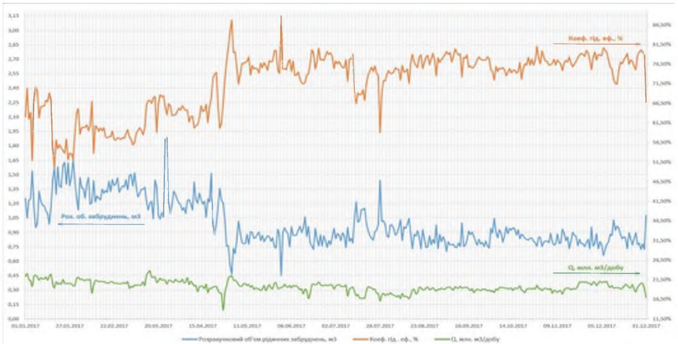
Рисунок 2.5 - Динаміка продуктивності та коефіцієнта гідравлічної ефективності в залежності від розрахункового об'єму забруднень
