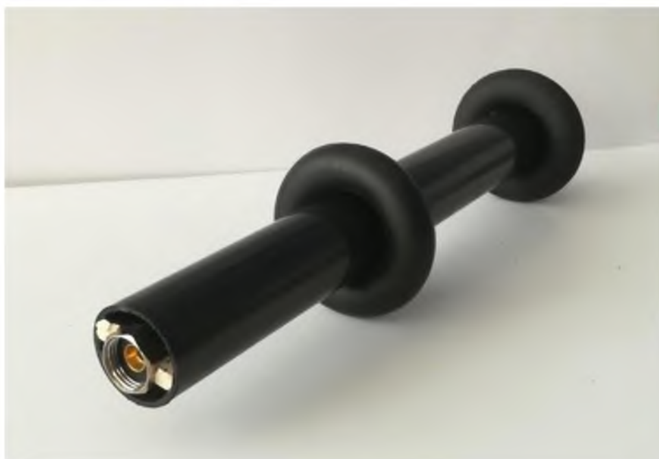
Рисунок 3.3 - Пристрій для очищення НКТ від забруднень
