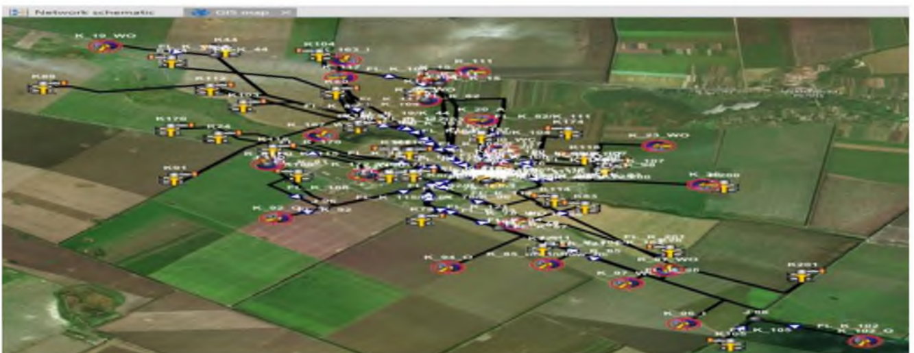
Рисунок 4.14 - Газозбірна система Котелевського ГКР
