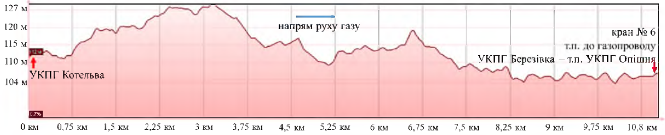
Рисунок 2.8 - План-профіль траси високонапірного газопроводу УКПГ Котельва – кран № 6 т. п. до газопроводу УКПГ Березівка – т. п. УКПГ Опішня (ділянка № 3)
