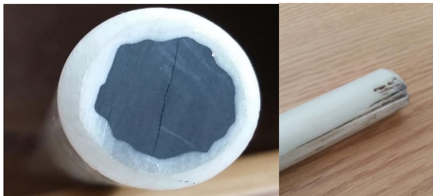
Рисунок 4.2 - Поперечний переріз гібридної насосної штанги з тріщиною, яка утворилася в вуглепластиковій серцевині (зліва) та розшарування склопластикової оболонки гібридної насосної штанги, яке утворилося після експлуатації в свердловині (справа) на промислах в Китаї.
