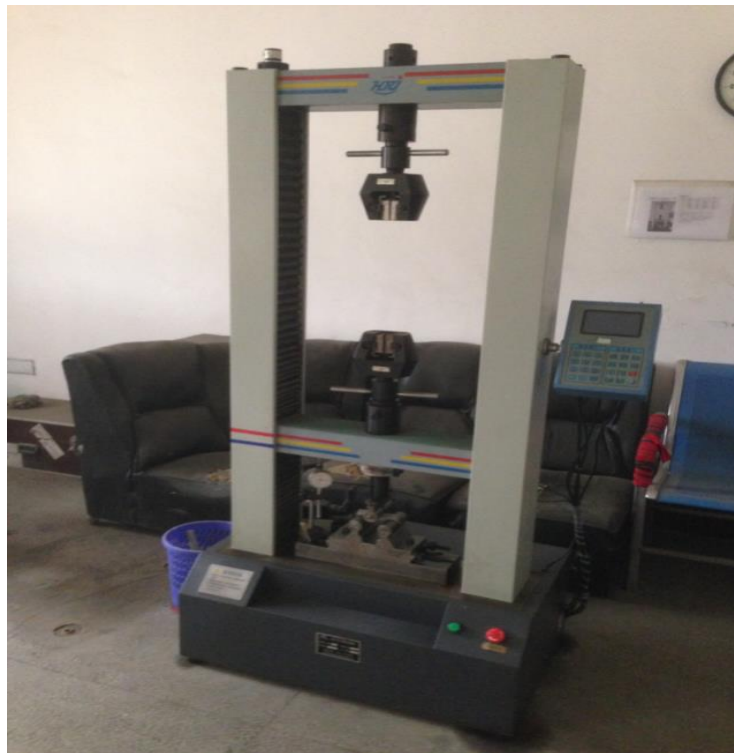
Рисунок 2.3 - Стенд для випробування на втомну міцність гібридних насосних штанг за циклічного розтягу
