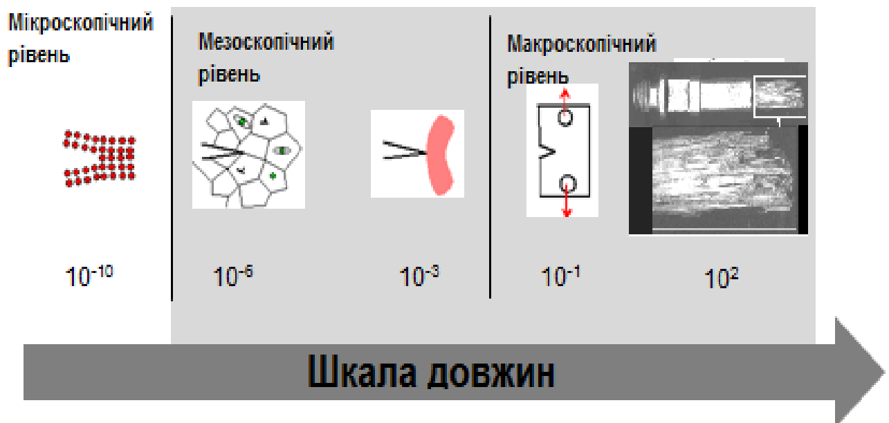
Рисунок 2.4 - Рівні руйнування полімерних композитів
