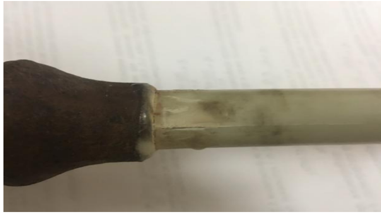
Рисунок 4.4 - Загальний вигляд зразка гібридної штанги з повздовжнім розшаруванням (з довжиною тріщини до 32 мм) після випробовувань на втому при згині
