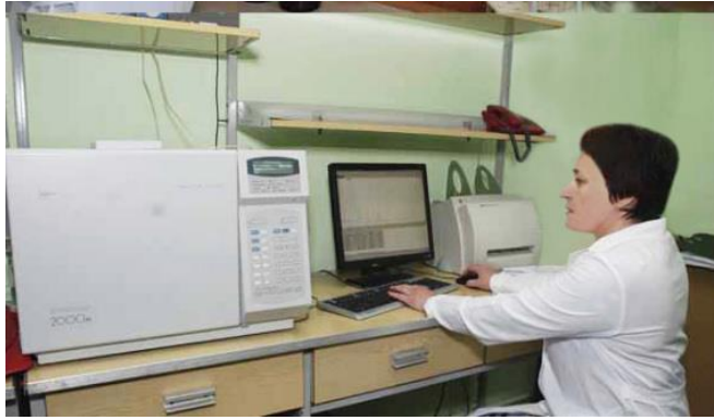
Рисунок 2.3 - Визначення фізико-хімічних показників проби природного газу за допомогою хроматографічного комплексу «Кристалл 2000м» (ПАТ «Івано-Франківськгаз»)
