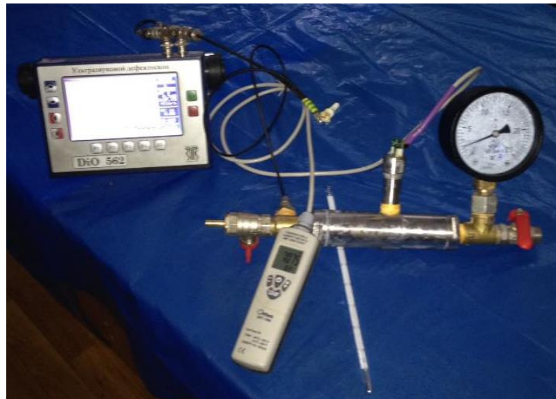
Рисунок 4.3 - Зовнішній вигляд спрощеної експериментальної установки для визначення температурного коефіцієнту швидкості ультразвукових коливань у природньому газі
