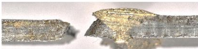
Рисунок 4.8 – Зруйноване з'єднання труб
