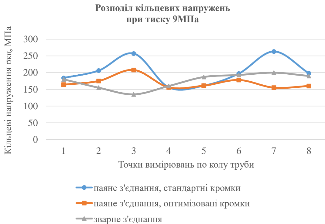
Рисунок 4.17 – Розподіл кільцевих напружень по зовнішній стінці труби при навантаженні внутрішнім тиском
