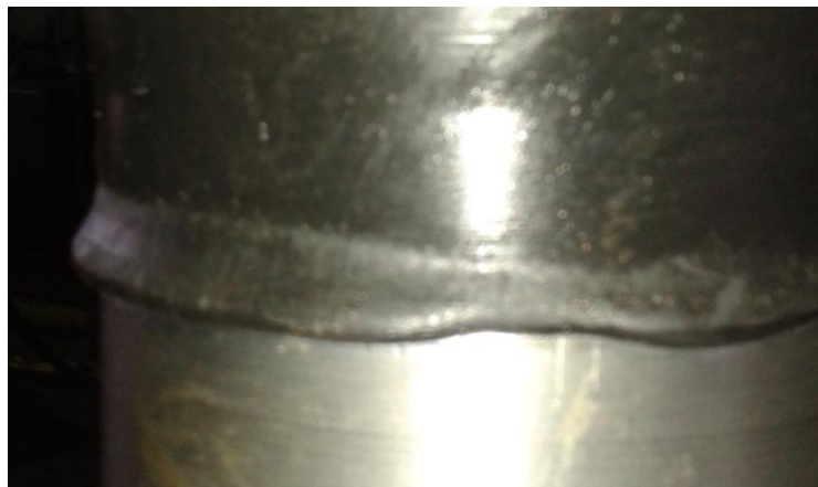
Рисунок 3.18 – Загальний вигляд опорної частини манжети після вилучення пакера із лабораторного стенду
