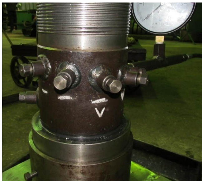
Рисунок 3.19 – Спіральне виконання радіальних випробувальних отворів для визначення контактних тисків на спряженій поверхні «манжета – обсадна труба»
