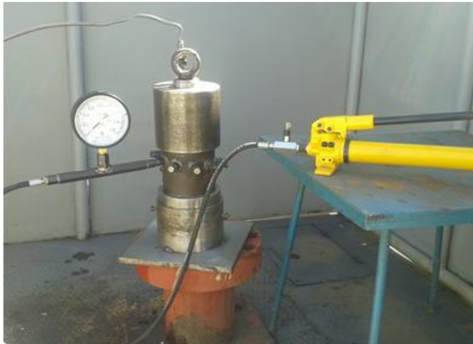
Рисунок 3.7 – Загальний вигляд лабораторного стану для дослідження контактних тисків
