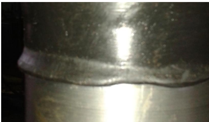
Рисунок 6 – Загальний вигляд опорної частини манжети після вилучення пакера із лабораторного стенду
