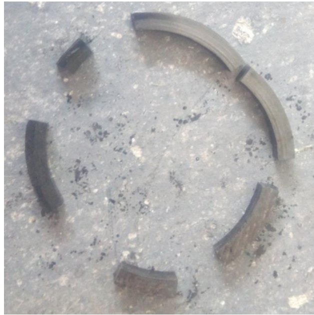
Рисунок 5.1 – Керамічне кільце насосу 4НГ5×2, що вийшло з ладу внаслідок терморозтріскування
