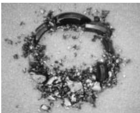
Рис. 1.19 – Характер руйнування кільця із SiC при виникненні сухого тертя внаслідок випаровування рідинної плівки при терті по контртілу із вольфрамового твердого сплаву [32]
