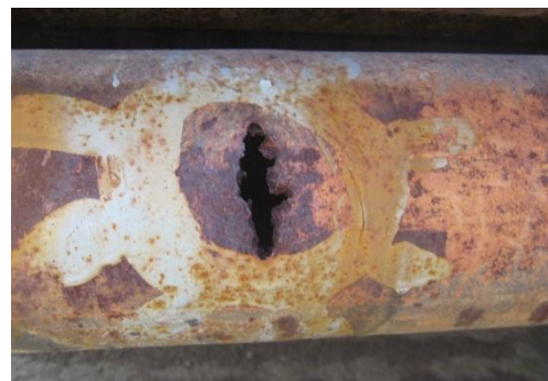
Рисунок 1.2 – Розмив різьбового з'єднання та тіла труби
