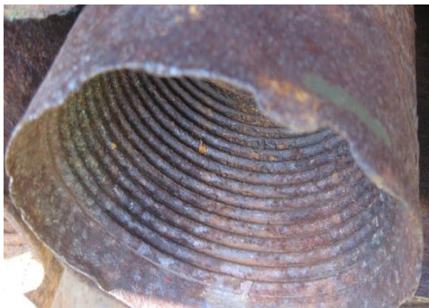
Рисунок 1.2 – Розмив різьбового з'єднання та тіла труби
