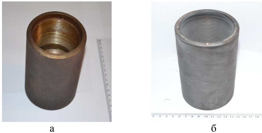
а – не зміцнений замок; б – зміцнений замок ІВГТЦПА.
