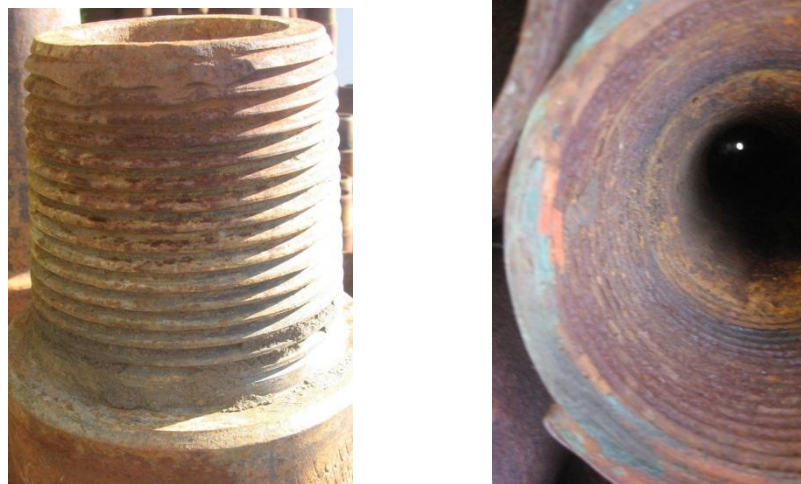
Рисунок 1.5 – Корозійне пошкодження елементів бурильної колони
