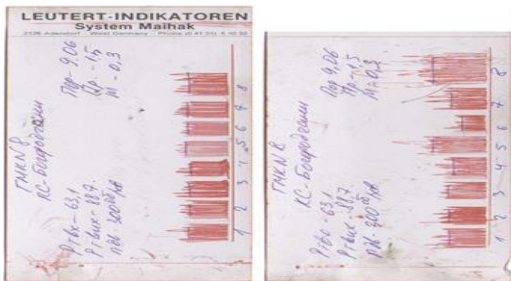
Рисунок 3.11 – Індикаторні діаграми силових циліндрів
