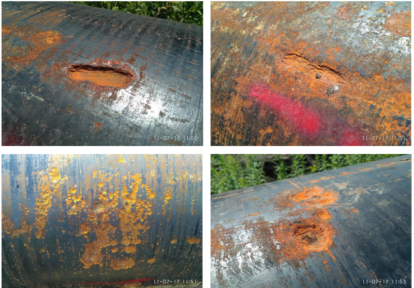
Рисунок 1.15 – Дефекти тіла труб МГ “Комарно – Дроздовичі” та МГ “Івацевичі – Комарно”. Джерело: ПАТ “Укртрансгаз”
