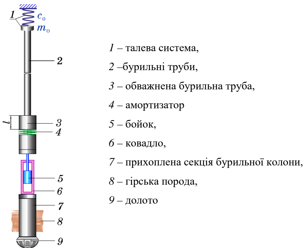
Рисунок 4.20 – Розрахункова схема бурильної колони з вмонтованим амортизатором та ударним механізмом
