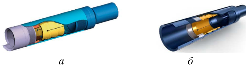
Рисунок 1.14 – Овершот, що застосовують для вилучення [73; 159]
