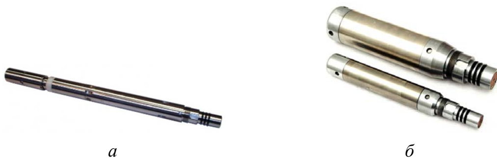
a – каротажний прихопленомір «Кедр», б – прихопленомір «Промгеофізсервіс»
