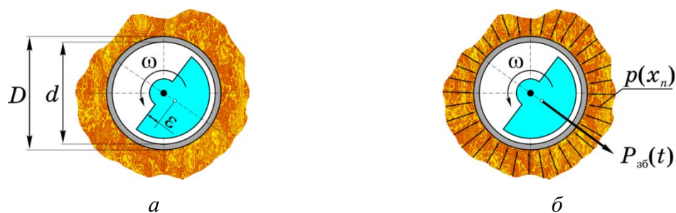
Рисунок Д.12 – Розрахункова схема дебалансного вібратора: a – кутова швидкість \omega і ексцентриситет \varepsilon ; б – розподілена сила тиску породи p(x_n) і збурювальна сила P_{36}(t)
