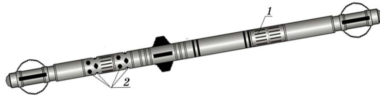
Рисунок Д.3 – Акустичний цементовимірювач: 1 – випромінювач, 2 – приймачі
