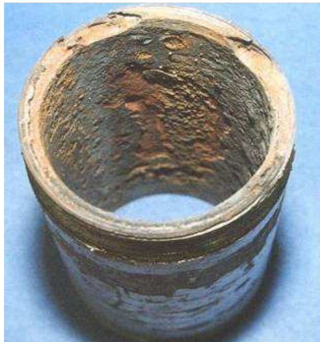
Рисунок 1.6 – Метал під дією щілинної корозії
