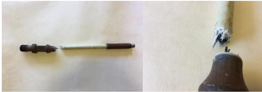
Рисунок 7 - Характерні дефекти і вид зламів відпрацьованих зразків
