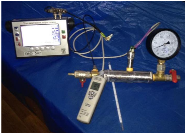
Рисунок 5 - Зовнішній вигляд спрощені експериментальної установки для визначення температурного коефіцієнту швидкості ультразвукових коливань у природному газі
