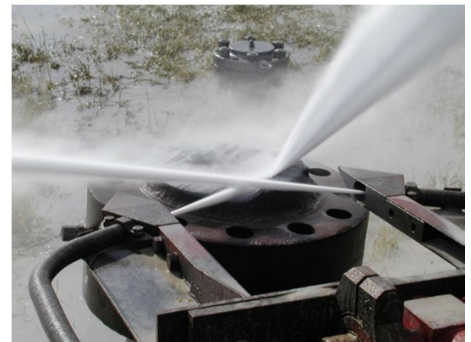
Рисунок 16 - Розміщення різальних насадок під кутом \alpha
