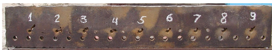
Рисунок 7 - Прорізана еталонна плита
