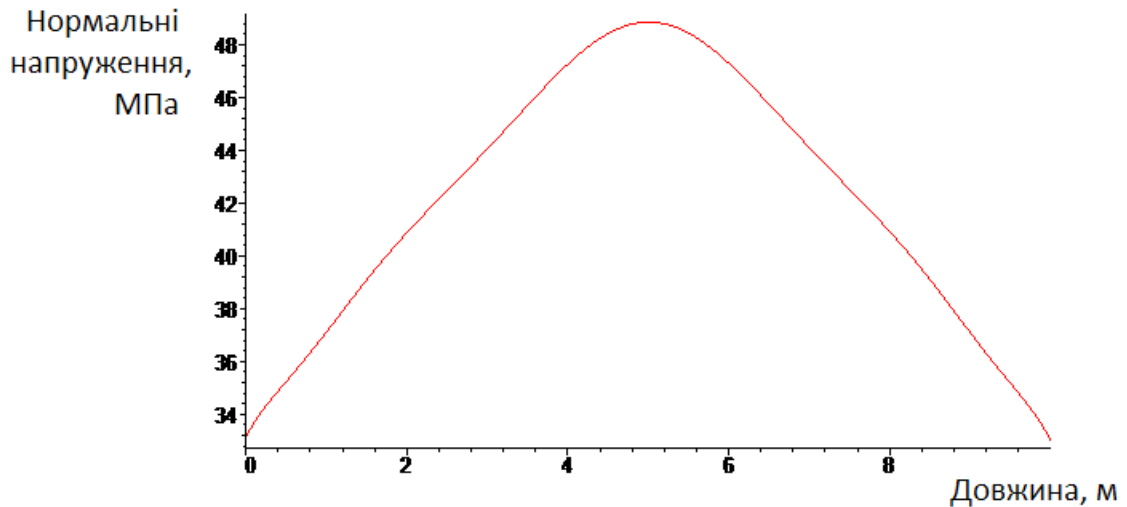
Рисунок 18 – Графік зміни нормальних напружень від згину в пристрої для вимірювання зусиль у буринній колоні
