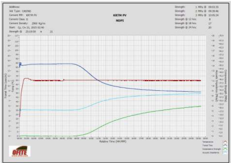
Рисунок 6 – Динаміка набору міцності тампонажної суміші КРТМ-ПВ для умов свердловини 36-а-Ярошівська
