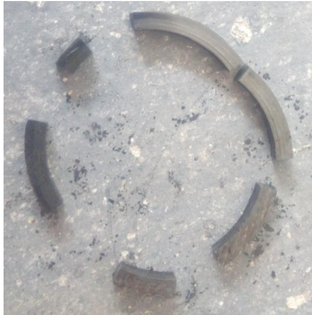
Рисунок 10 – Керамічне кільце насоса 4НГ5×2, що вийшло з ладу внаслідок терморозтріскування
