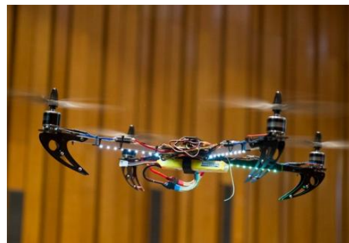
КВАДРОКОПТЕР- ВЕРТОЛІТ З КІЛЬКОМА НЕСУЧИМИ ГВИНТАМИ
