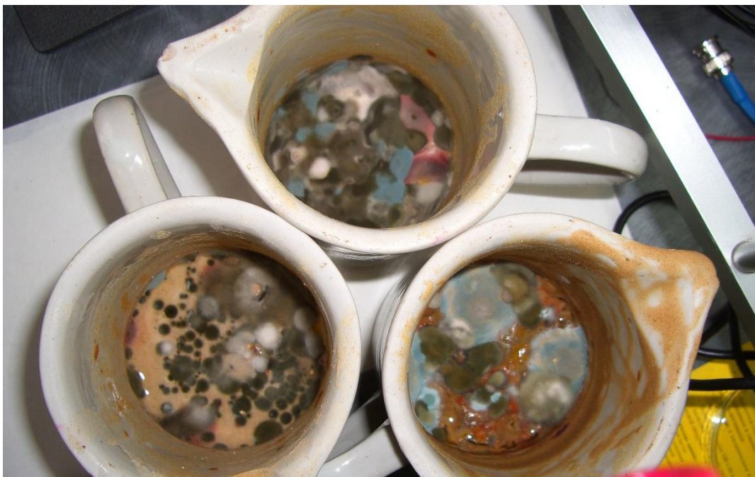
Рисунок 2.18 – Пліснява на поверхні базової біополімерної системи Біокар, як один із проявів біологічного розкладання полісахаридних реагентів
