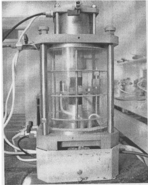
Рисунок 2.9 – Стабілометр – пристрій для визначення механічних характеристик керового матеріалу в умовах об’ємного напруженого стану
