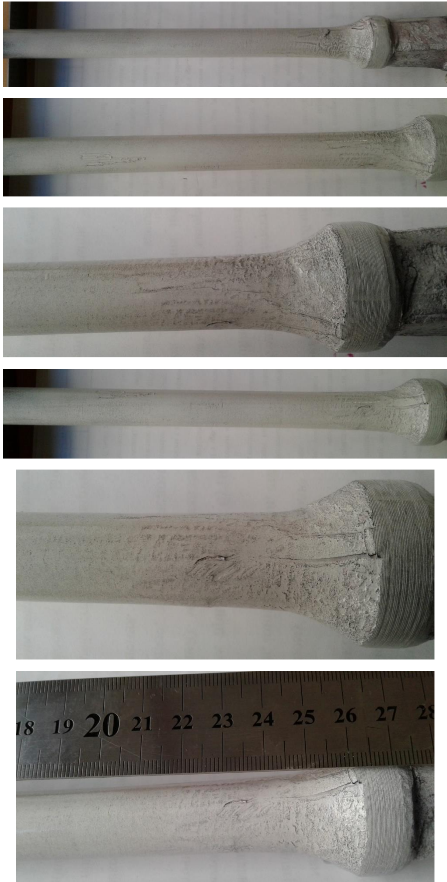
Рисунок 5.17 - Місця скупчення порошку на поверхні фрагменту штанги в процесі проведення магнітопорошкового контролю
