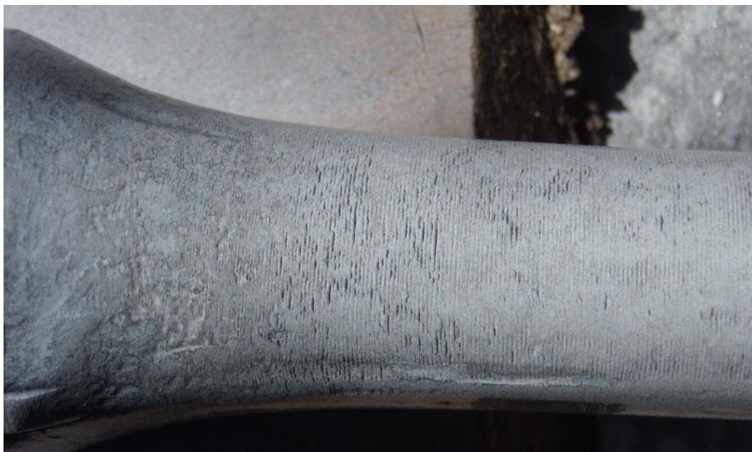
Рисунок 5.3 – Тріщини втоми, які утворилися в тілі насосної штанг після випробувань при змінному напруженні \sigma=140 МПа
