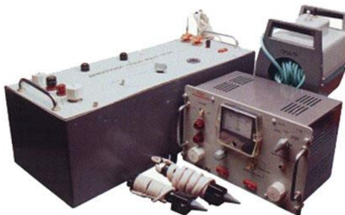
Рисунок 5.1 – Магнітний дефектоскоп ПМД-70
