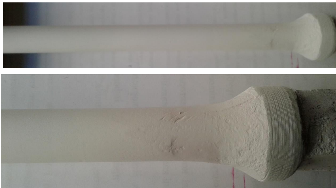
Рисунок 5.15 – Нанесення на фрагмент штанги шару білої фарби-контрасту
