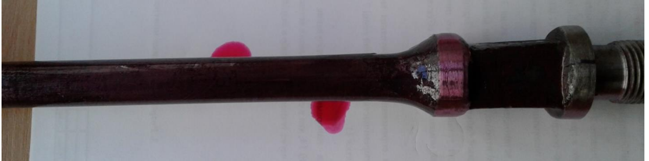
Рисунок 5.13 – Капілярний контроль фрагменту штанги
