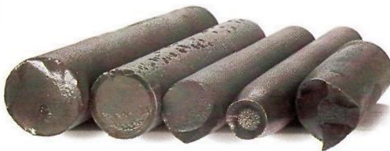
Рисунок 1.1 - Поломки від розтягу і втоми насосних штанг
