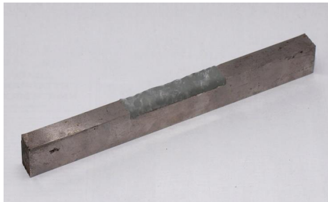
Рисунок 2.12 – Зразок з короткою втомною тріщиною, закритою нанесеним покриттям
