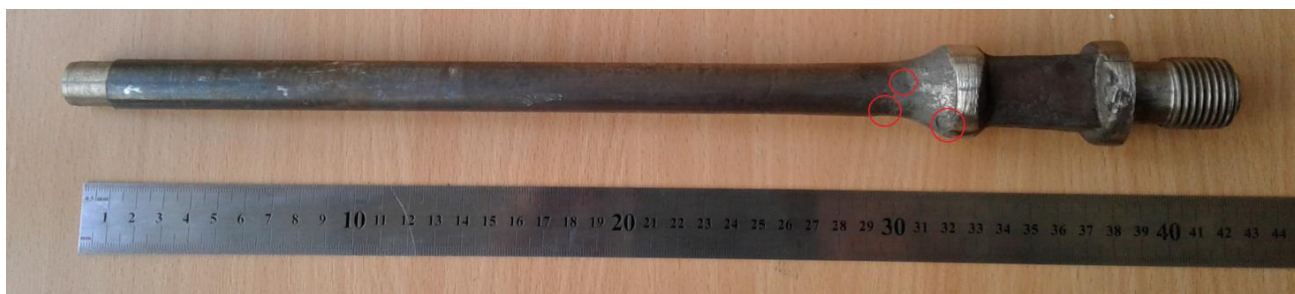
Рисунок 5.12 - Фрагмент штанги зі слідами загальної корозії в поєднанні з локальними ділянками корозійних виразок
