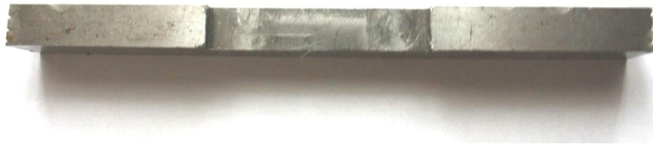
Рисунок 2.11 – Зразок із зішліфованою в його робочому діапазоні верхньою частиною з боку концентратора із втомною тріщиною
