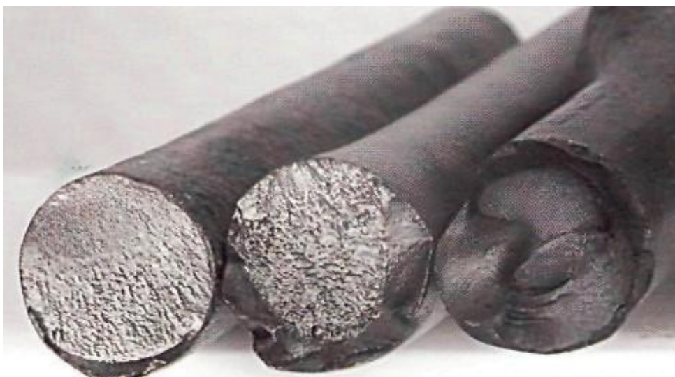
Рисунок 1.2 - Втомні злами зігнутих насосних штанг
