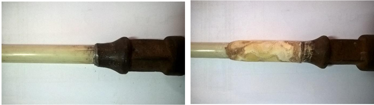
Рисунок 5.21 – Загальний вигляд зразка гібридної штанги з повздожнім розшаруванням та склопластиковим бандажем для випробувань на втому при згині
