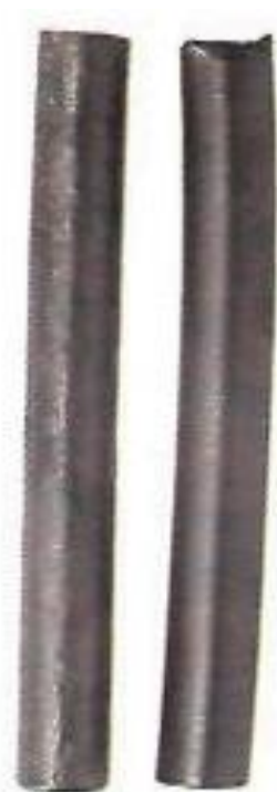
Рисунок 1.3 - Втомні злами зігнутих штанг (вид з боку)
