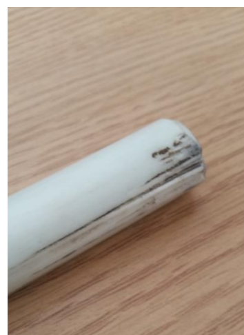
Рисунок 5.19 – Поперечний переріз гібридної насосної штанги з тріщиною, яка утворилася у вуглепластиковій серцевині (зліва) та розшарування склопластикової оболонки гібридної насосної штанги, яке утворилося після експлуатації в свердловині (справа) на промислах у Китаю
