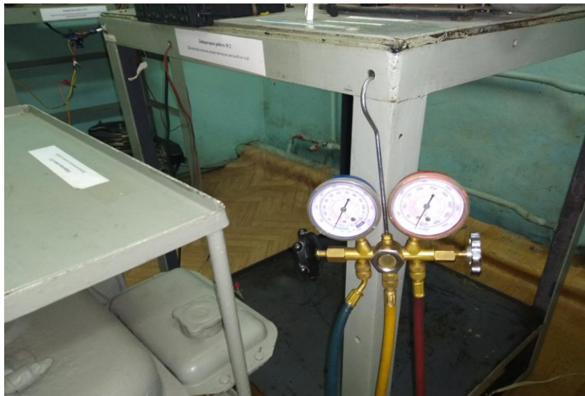
Рисунок 4.13 – Манометричний колектор для вимірювання тиску стисненого газу установки
