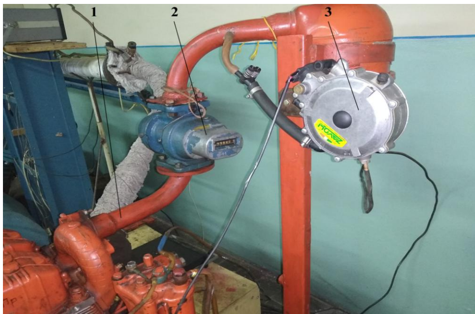
Рисунок 4.5 – Переобладнана з дизельного палива на газове паливо система живлення
