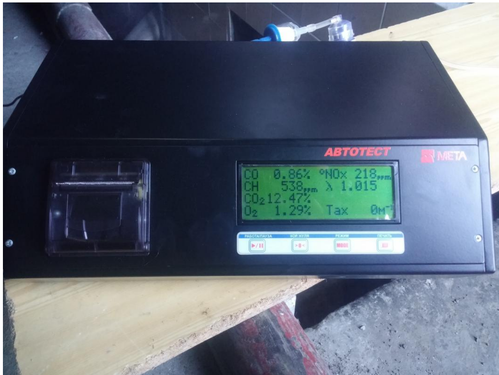
Рисунок 4.16 – Газоаналізатор Автотест-02.03П для вимірювання вмісту оксидів азоту
