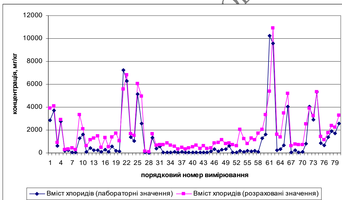
Рис. 5.8. Порівняння модельних (розрахованих) значень концентрацій хлоридів та значень натурних вимірювань для ґрунтів з високим вмістом токсичних солей
