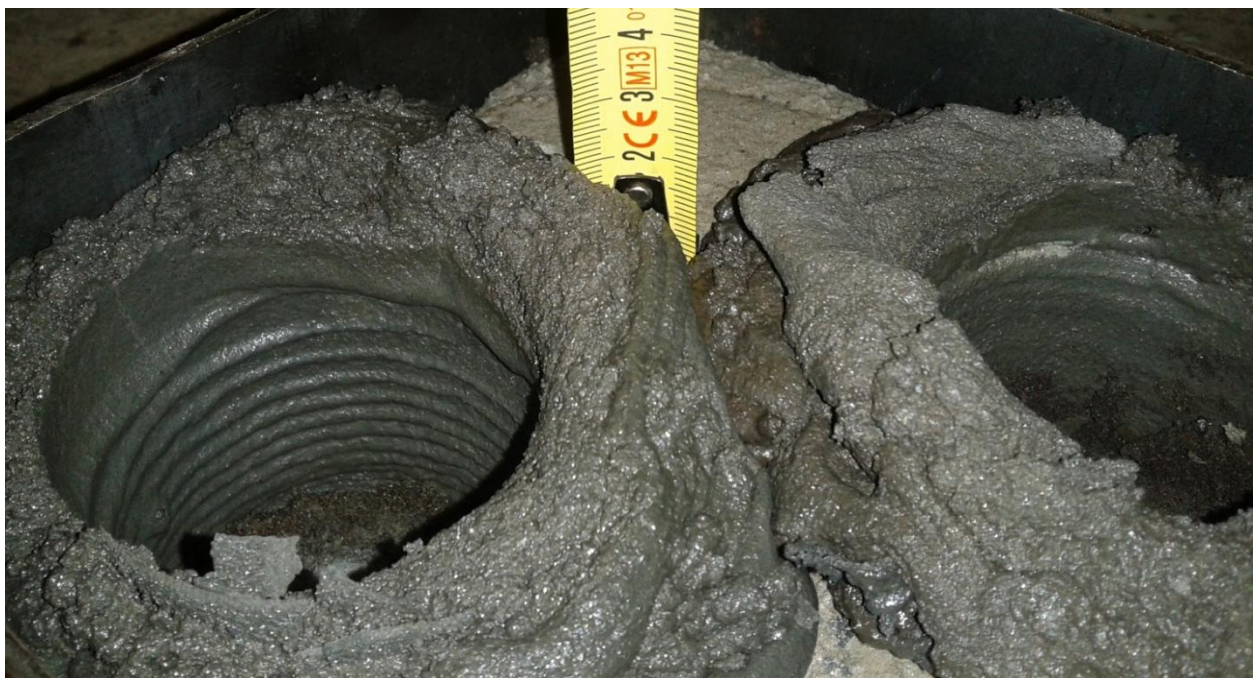
Рисунок 3.13 – Зовнішній вигляд розплаву (тампонажного каменю), отриманого при частоті обертання 500 \text{ хв}^{-1} і осьового навантаження 700 \text{ даН} , для ТПКМ із співвідношенням компонентів 1:3
