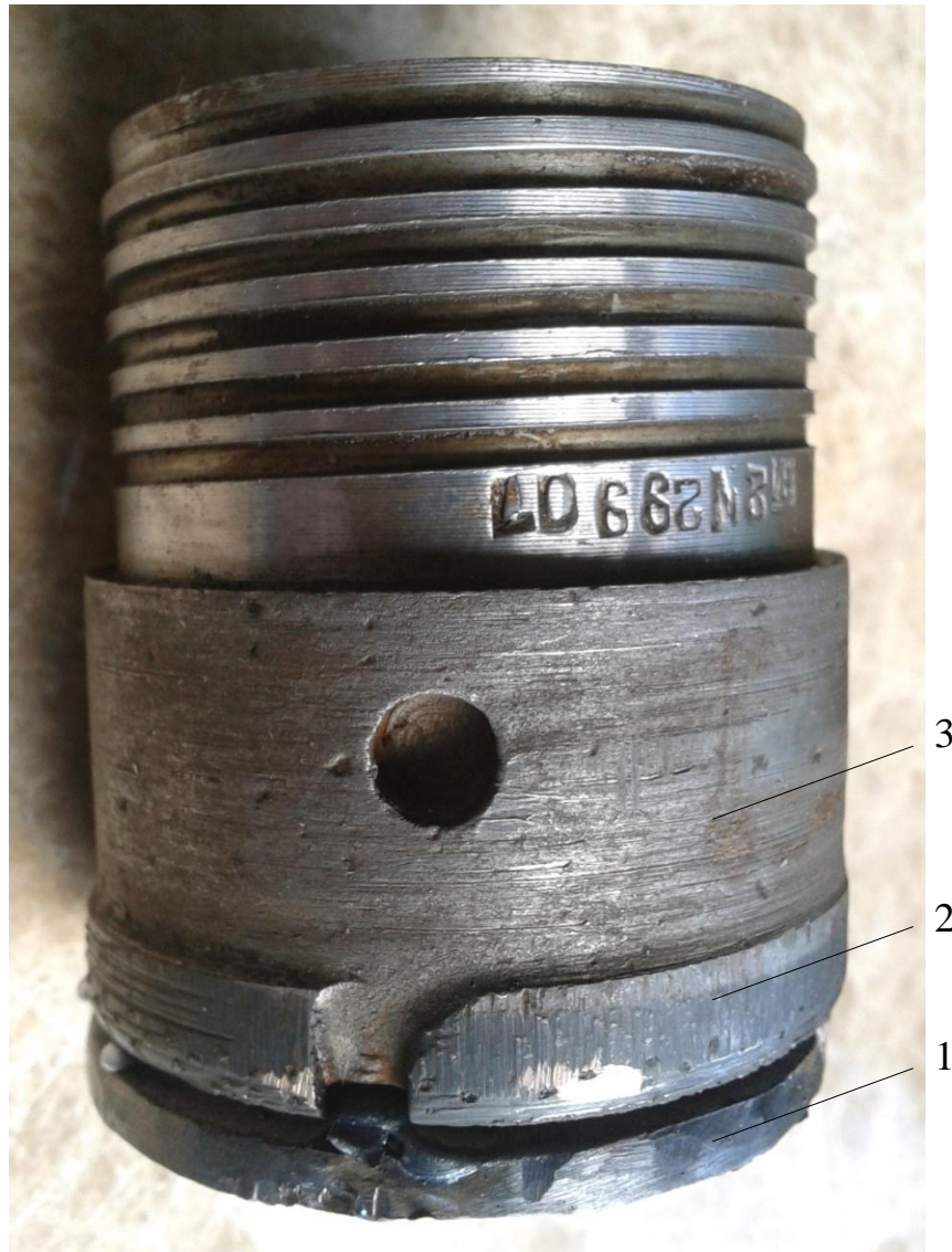
Рисунок 3.4 – Термомеханічний породоруйнівний інструмент
