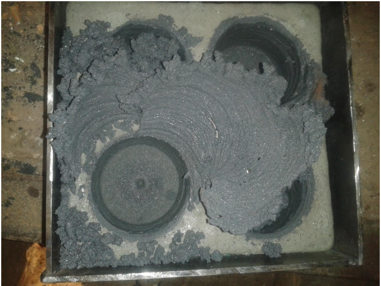
Рисунок 3.13 – Зовнішній вигляд розплаву (тампонажного каменю), отриманого при частоті обертання 500 \text{ хв}^{-1} і осьового навантаження 700 даН, для ТПКМ із співвідношенням компонентів 1:4
