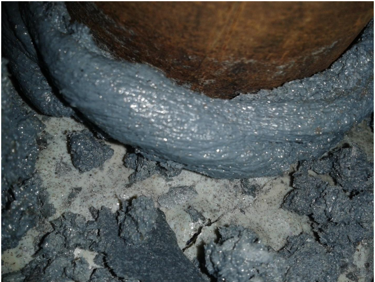
Рисунок 3.11 – Зовнішній вигляд розплаву (тампонажного каменю), отриманого при частоті обертання 500 \text{ хв}^{-1} і осьового навантаження 700 \text{ даН} , для ТПКМ із співвідношенням компонентів 1: 1
