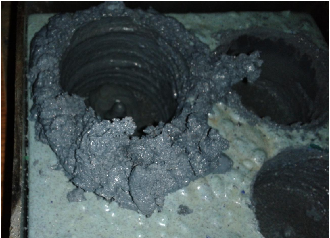
Рисунок 3.12 – Зовнішній вигляд розплаву (тампонажного каменю), отриманого при частоті обертання 500 \text{ хв}^{-1} і осьового навантаження 700 \text{ даН} , для ТПКМ із співвідношенням компонентів 1:2
