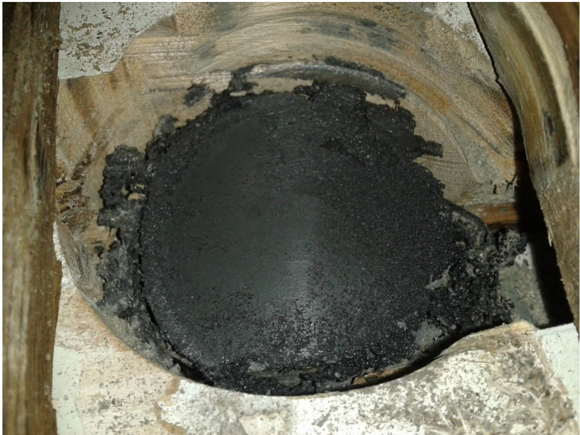
Рисунок 3.14 – Зовнішній вигляд приробленої поверхні ТПКМ
