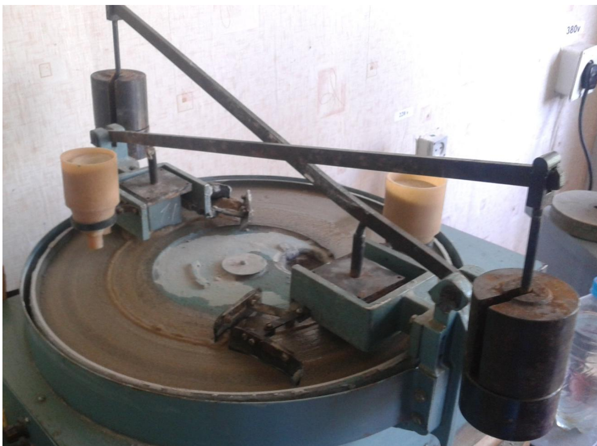
Рисунок 2.17 – Стирання експериментальних зразків на ЛКИ–3
