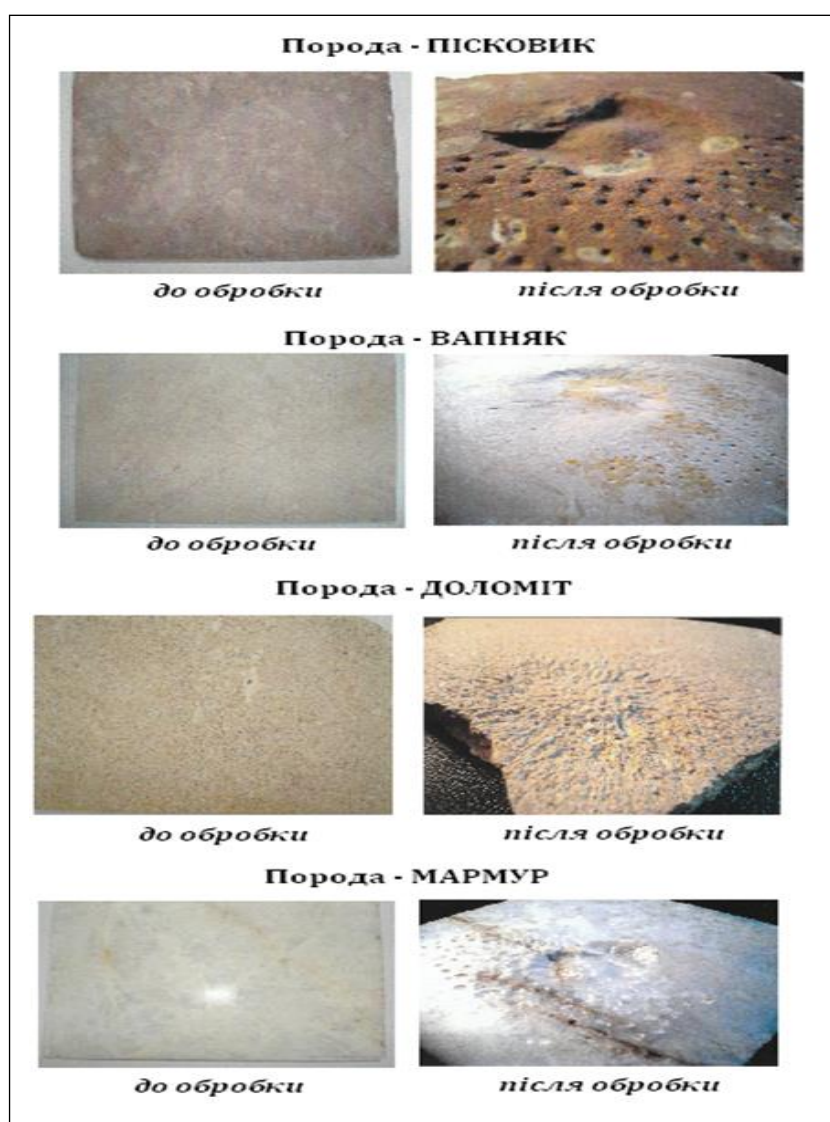
Рисунок 5.7 – Вигляд досліджуваних взірців гірських порід до і після дії на них кавітаційно-пульсуючих потоків
