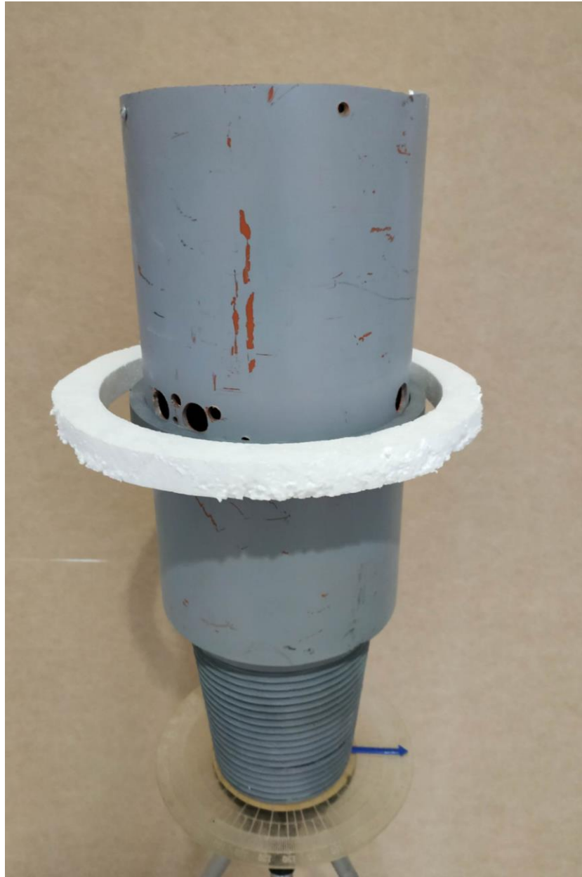
Рисунок 5.10 – Стенд для проведення замірів величини ексцентричного зміщення
