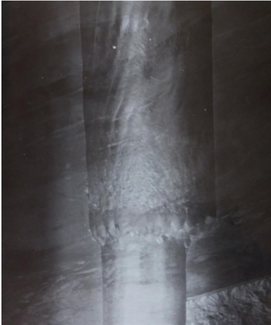
Рисунок 1.4 – Форма стовбура свердловини при ексцентричному розширенні
