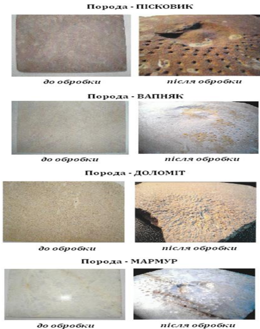
Рисунок 13 - Вигляд досліджуваних взірців гірських порід до і після дії на них кавітаційно-пульсуючих потоків
